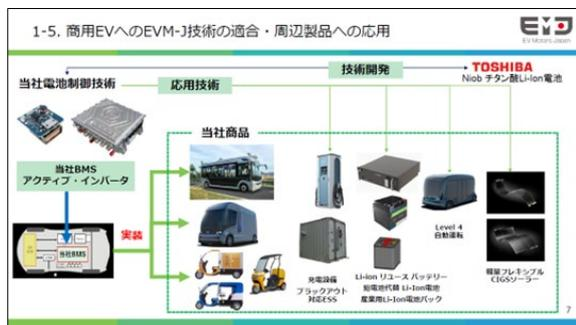
同社のBMS（バッテリーマネジメントシステム）技術は特に独自性に優れており、コントローラがEV車の電池の状況やモーターの出力状況、速度を加味し、電池の劣化が起こらないように出力を制御しな
